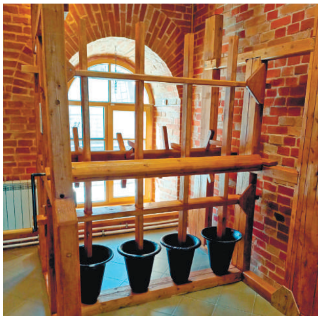
Рис. 3. Толчельня для перемалывания руды Fig. 3. Ore grinding mill
